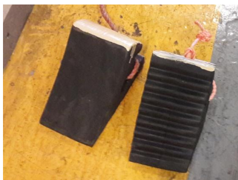
Εικόνα 13: Σφήνες αναστολής κύλισης (τάκοι) Φ/Γ οχημάτων
