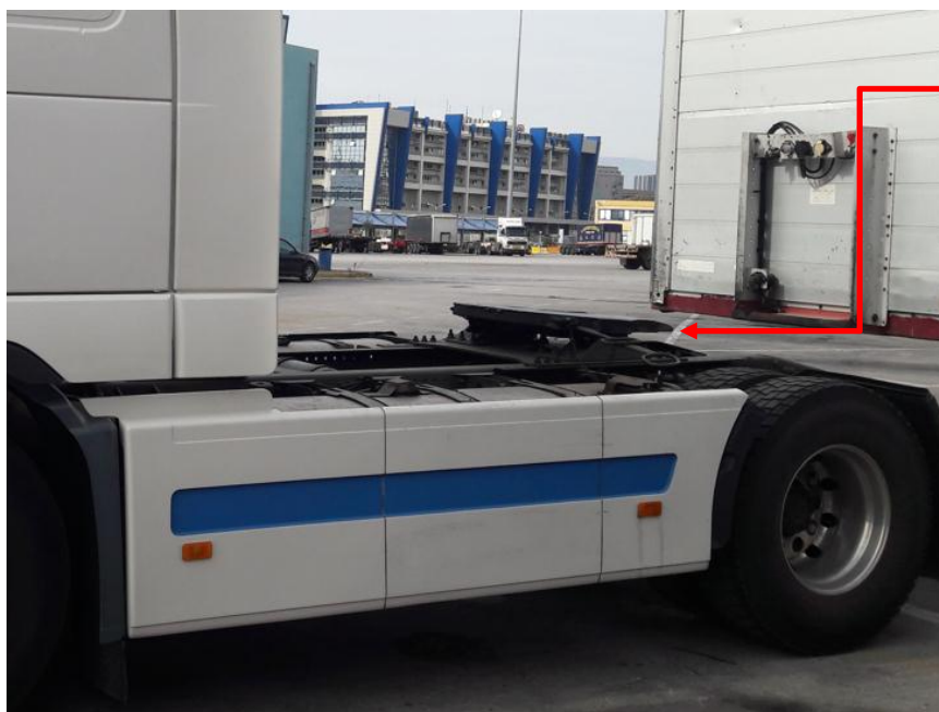
Εικόνα 9: Η πλάκα επικαθήσεως του ελκυστήρα
