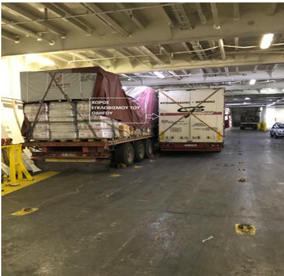
Εικόνα 1 : Απεικόνιση του χώρου όπου εγκλωβίστηκε ο οδηγός κατά τη διαδικασία σύνδεσης του ελκυστήρα με το επικαθήμενο
