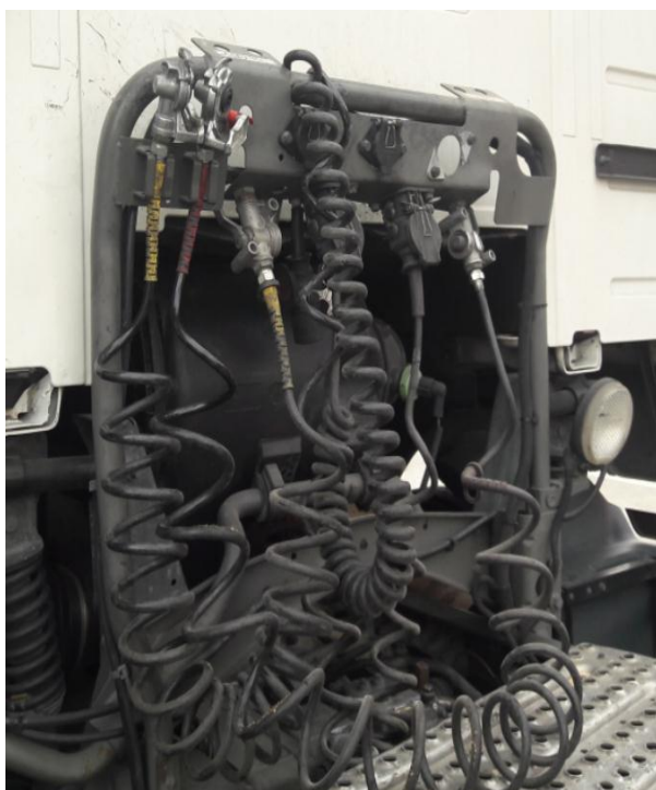
Εικόνα 10: Πλατφόρμα ζεύξης ελκυστήρα με τα καλώδια τροφοδοσίας ρεύματος και παροχής αέρα στο ρυμουλκούμενο
