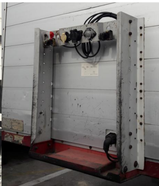
Εικόνα 11: Πλατφόρμα ζεύξης επικαθήμενου με τους υποδοχείς καλωδίων τροφοδοσίας ρεύματος και αέρα
